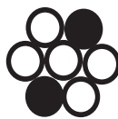
Tipo "N" 5 alambres copperweld 2 alambres de cobre
