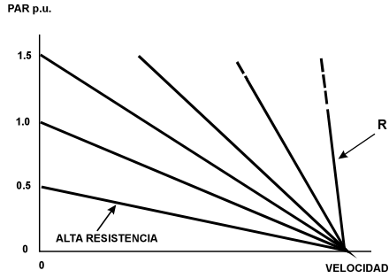
INFLUENCIA DE LA RESISTENCIA EXTERNA DEL ROTOR (R) SOBRE LA CURVA PAR - VELOCIDAD DE UN MOTOR DE ROTOR DEVANADO
